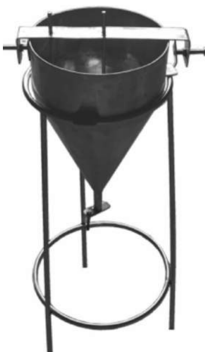
Hình 3.13. Côn thử độ chảy của vữa dùng bơm vào ống cooling pipe
