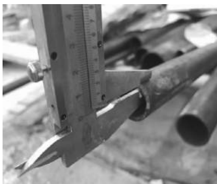
Hình 3.2. Kiểm tra độ dày ống thép
