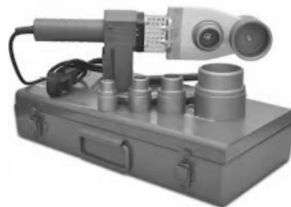
**Hình 3.3.** Máy hàn ống nhiệt PPR
