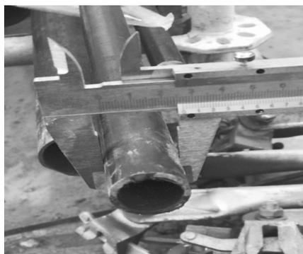
**Hình 3.1.** Kiểm tra đường kính ống thép
