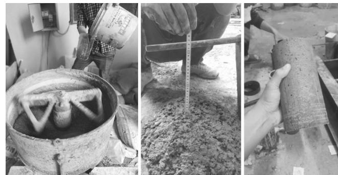
Hình 3. a) Trộn bê tông; b) Thí nghiệm với côn Abrams xác định độ sét của hỗn hợp bê tông; c) Mẫu bê tông đất hình trụ tròn 150x300mm.
