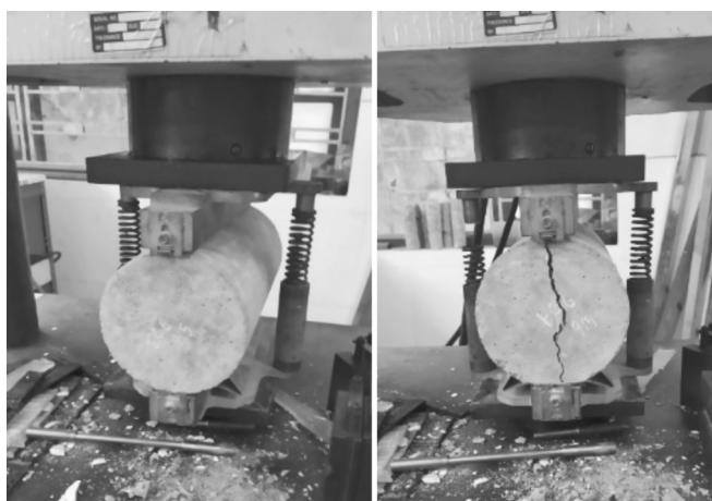
Hình 5. Thí nghiệm xác định cường độ ép chẻ của bê tông đất
